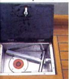
asciutte. Risolto anche l'annoso problema delle fuoriuscite di gasolio sul teak, i tappi di imbarco e gli sfiati dei serbatoi sono infatti piazzati dentro botole incassate sui passavanti e dotate di fori di drenaggio che scaricano sulla linea di galleggiamento. Pulita e funzionale la soluzione del musone di prua, con entram-
