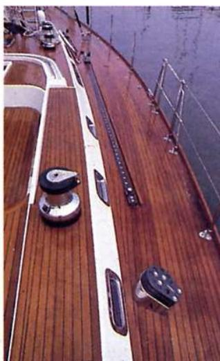
*Anche gli oblò laterali sono in acciaio inox, con bordi inferiori inclinati per drenare l'acqua.*
